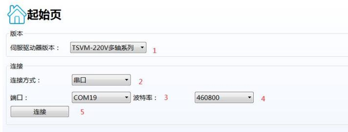
图 4-2 软件连接顺序步骤图
